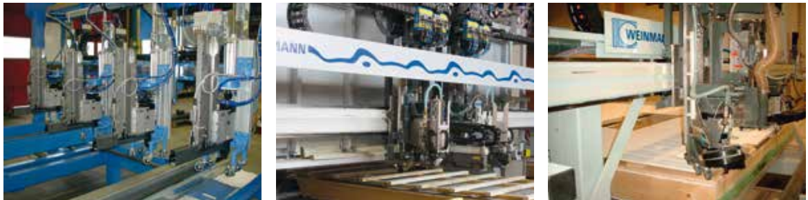
Estación de grapado integrada dentro de línea de producción
